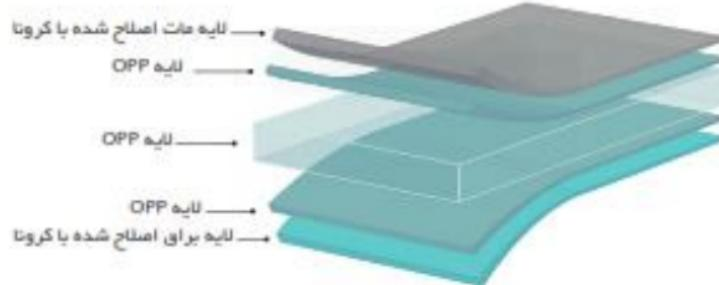
کاربرد: فیلم مات مناسب جهت لمینیت یا کارتن و کاغذ دارای خاصیت آنتی استاتیک مناسب، جهت جلوگیری از تجمع گرد و غبار بر روی سطح فیلم.
